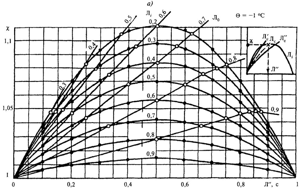
$\chi = \frac{v_{\text{ср}}^{\text{ср}}}{v_p^{\text{ср}}}$  — коэффициент анизотропии;  $L_c$  — суммарная льдистость;  $L''$  — слоистый лед;
