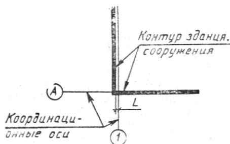
**Примечание** -  $L$  - расстояние от внутренней грани контура здания, сооружения до координатной оси.
